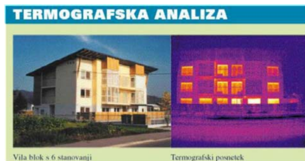
Slika 5. Ilustrativni prikaz termograma u energijskoj iskaznici zgrade [11]
