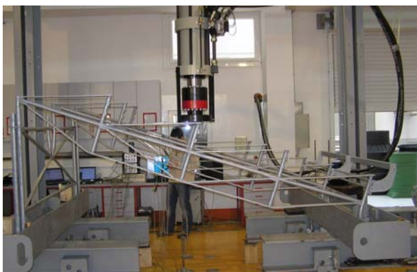
Slika 8. Ispitivanje glavnog nosača tribina u laboratoriju
