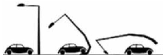
Slika 16. Ponašanje stupova koji apsorbiraju malo energije [5]
