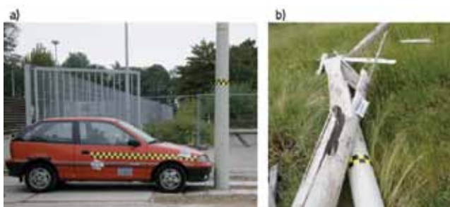
Slika 18. Pokusni sudar pri brzini 100 km/h [9]; a) vozilo i stup prije sudara, b) stup nakon sudara - brzina vozila smanjena je na oko 60 km/h
