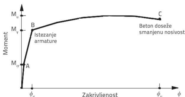
Slika 6. Odnos momenta i zakrivljenosti
