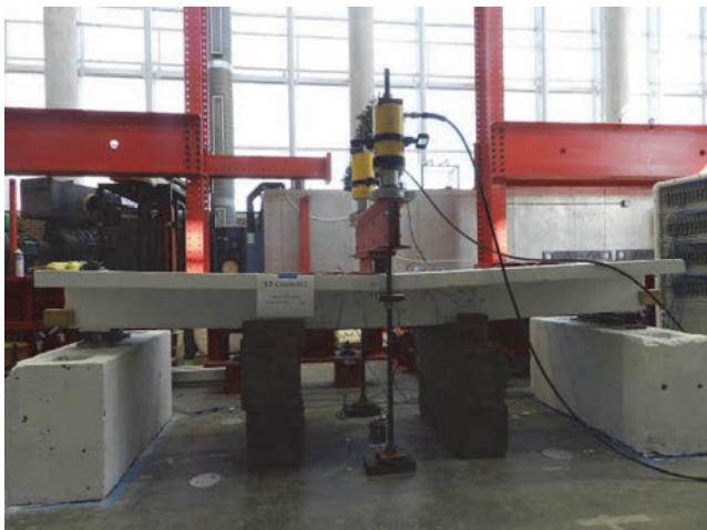
Slika 20. Uzorak ispitivanja neposredno prije loma
