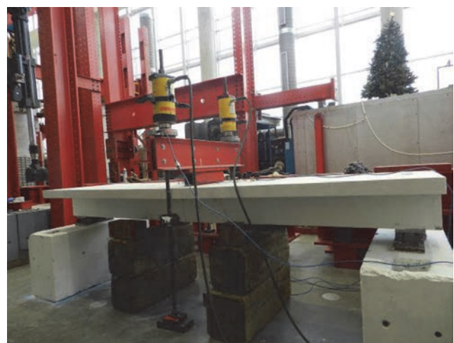
Slika 14. Probni uzorci nakon početnog opterećenja i rasterećenja
