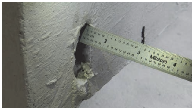
Slika 16. Klizanje na desnom kraju prednjeg CFCC užeta
