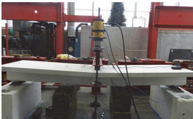
Slika 15. Uzorak grede pri lomu
