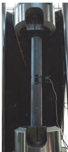
Slika 3. Ispitivanje CFCC uzorka na vlak pomoću ekstenzometra [15]
