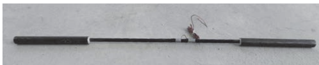
Slika 2. Uzorak CFCC s mjernom vrpcom - EOT [15]
