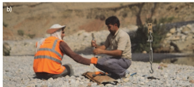
Slika 5. a) senzor DCDT postavljen na sredini raspona, b) kabel DCDT učvršćen na čelični prag postavljen ispod raspona
