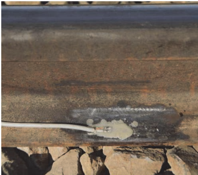
Slika 7. Tenzometar postavljen na nožicu tračnice radi određivanja točne brzine i lokacije osovina testnog vlaka
