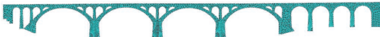
Slika 18. Jednostavni dvodimenzionalni model mosta Mianeh
