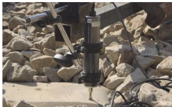
Slika 6. Senzor LVDT postavljen na prag
