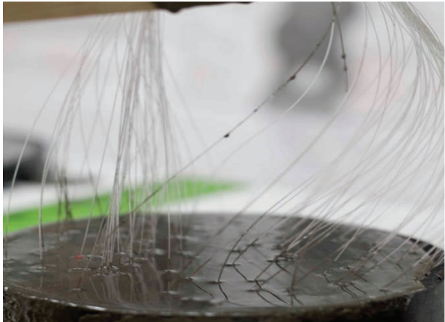
Priprema betona s optičkim vlaknima
