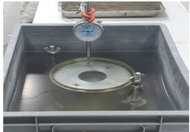
Slika 3. Stvrdnuti (osušeni) uzorak za CBR pokus
