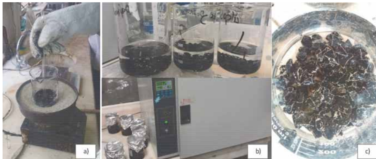
Slika 3. Faze ispitivanja po Nicholsonu: a) miješanja bitumen-agregata; b) kondicioniranje uzorka; c) promatranje uzorka
