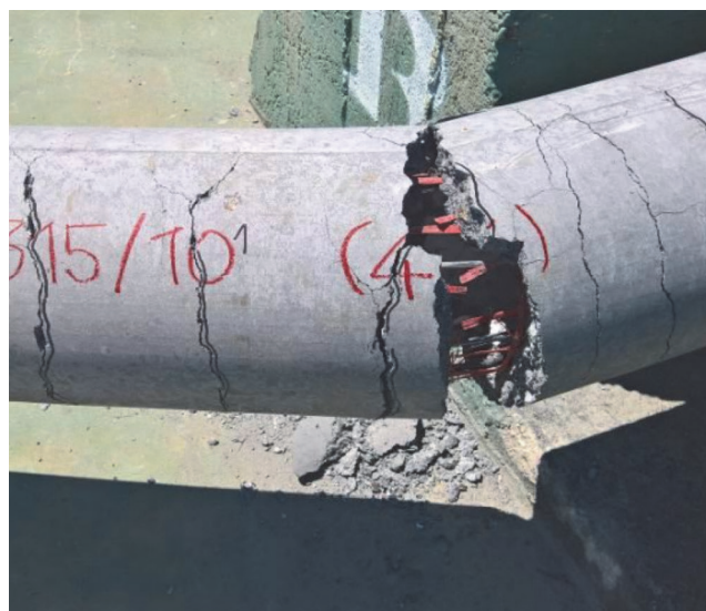
Slika 13. Karakteristični slom uzorka stupa armiranog CFRP šipkama i posmičnom mrežicom
