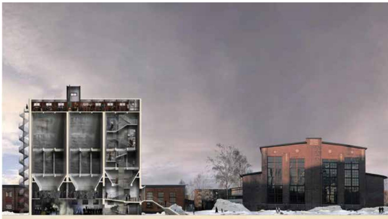
Novo stubište prolazi kroz postojeću betonsku konstrukciju silosa
