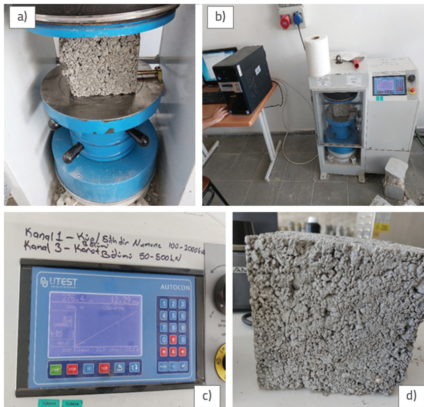
Slika 14. a) Uređaj za tlačno ispitivanje; b) i c) Status ispitivanja i dobiveni podaci; d) Uzorak uvaljanog betona nakon ispitivanja
