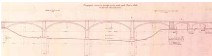
Slika 3. Uzdužni presjek mosta iz originalnog projekta Milivoja Frkovića
