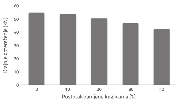
Slika 6. Granično opterećenje "Bubble Deck" ploče pri statičkom ispitivanju
