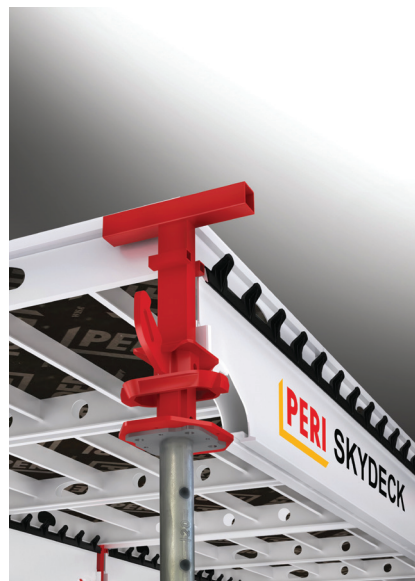
Sofisticirani sustav SKYDECK padajuće glave dopušta prijevremenu demontažu
