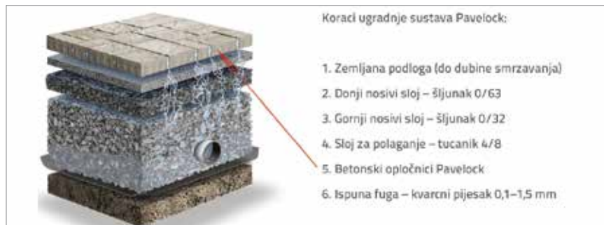
Priprema podloge za betonske opločnike Pavelock
