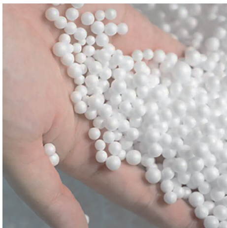
Slika 1. Uniformne kuglice osnovnog EPS-a
