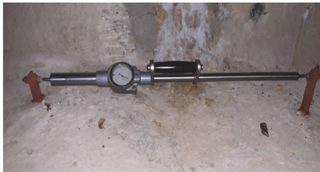
Slika 3. Deformetarsko mjesto na kruni brane (lamela 9) na kojem su provedena mjerenja korištena za neuralnu mrežu
