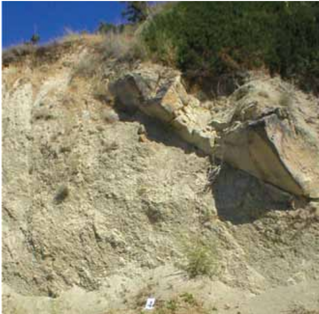
Slika 4. "Konzola" od čvršćeg sloja pješčenjaka na kosini (diferencijalna rastrošba po kosini)
