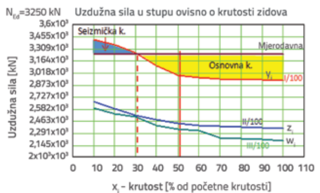
Slika 11. Promjena uzdužne sile u stupovima ovisno o promjeni krutosti zidova i prikaz granične krutosti zidova za seizmičku i osnovnu proračunsku kombinaciju
