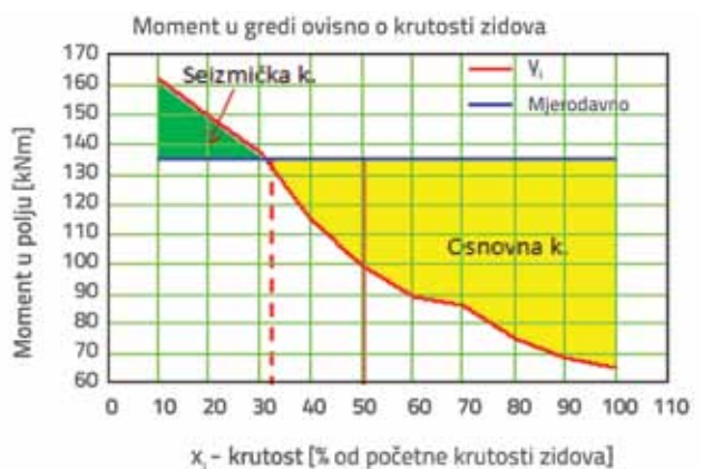
Slika 12. Promjena momenta savijanja u polju u gredi ovisno o promjeni krutosti zidova i prikaz granične krutosti za seizmičku i osnovnu proračunsku kombinaciju
