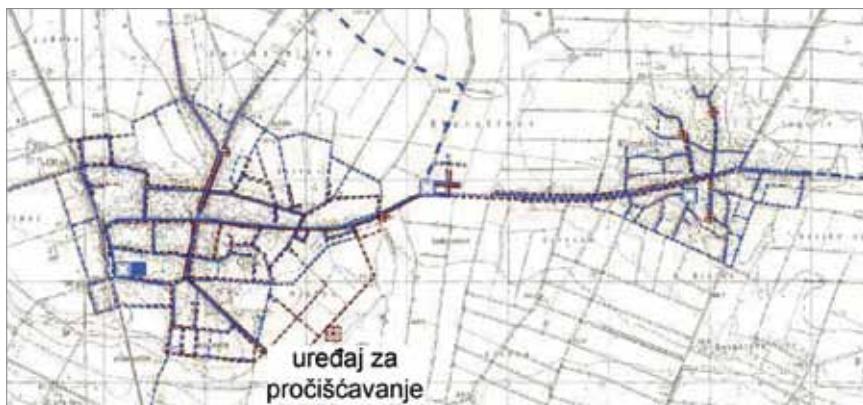
Sustav odvodnje otpadnih voda Otoka i Komletinaca
