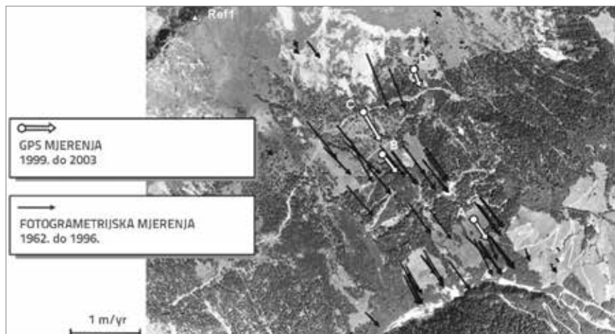
Slika 2. Usporedba pomaka dobivenih fotogrametrijskim metodama i GPS mjerenjima na primjeru klizišta u Austriji [22]
