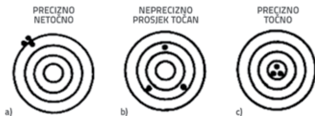
Slika 10. Shema tumačenja točnosti i preciznosti prema Dunicliffu [29]
