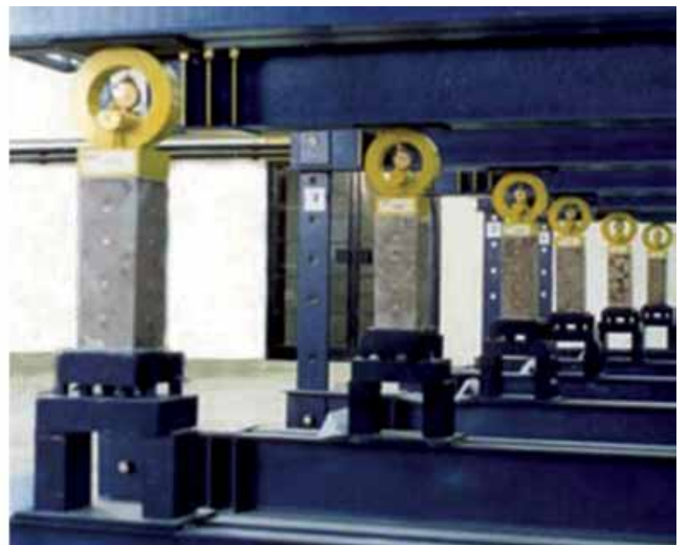
Slika 5. Uzorak za ispitivanje sa shemom mjernih mjesta te prikaz uzoraka tijekom ispitivanja
