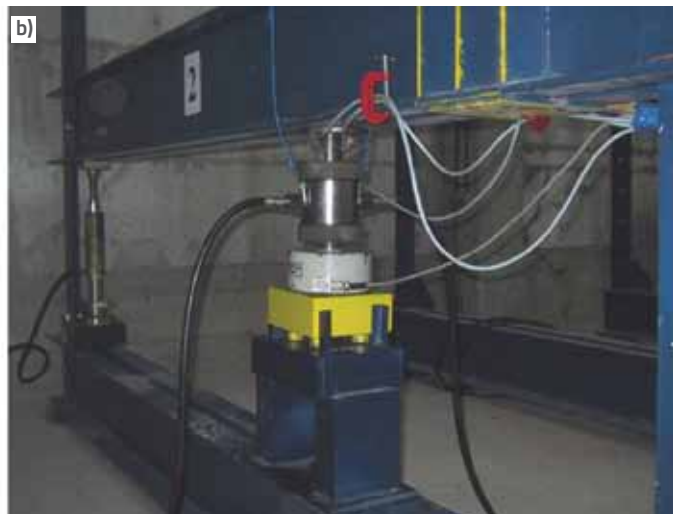
Slika 8. a) Cilindrični uzorak za standardno troosno ispitivanje; b) uređaj za troosno ispitivanje puzanja (karakteristični prikaz)
