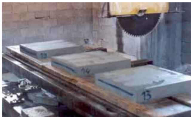
Slika 2. Izrada uzoraka: a) rezanje ploča 60x60x10 cm na stroju s rotacijskom pilom \phi 70 cm; b) zaštita uzorka parafinom
