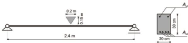
Slika 16. Geometrijske karakteristike armiranobetonske grede
