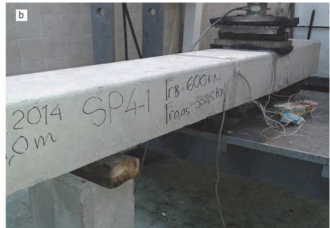
Slika 5. Prikaz dinamičkog ispitivanja praga: a) način oslanjanja praga; b) postupak opterećivanja praga
