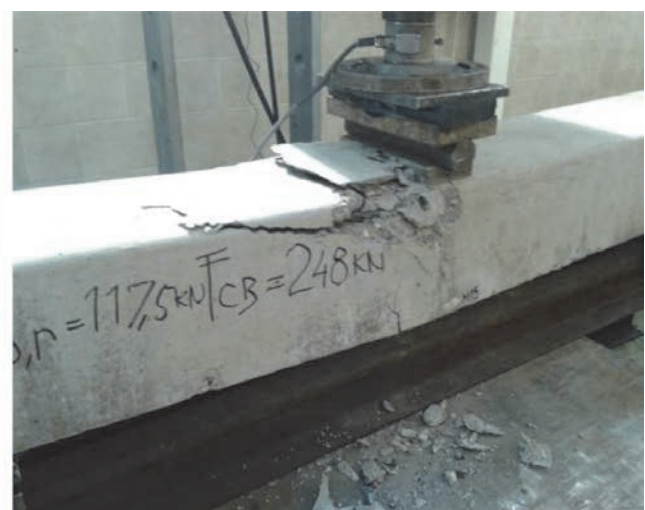
Slika 10. Lom pri dinamičkom ispitivanju skretničkoga praga SP-8 pri maksimalnoj sili F_{cb} = 248 kN
