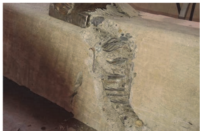
Slika 6. Lom pri dinamičkom ispitivanju reprezentativnog praga L = 4,0 m pri najvećoj sili F_{rb} = 570 kN
