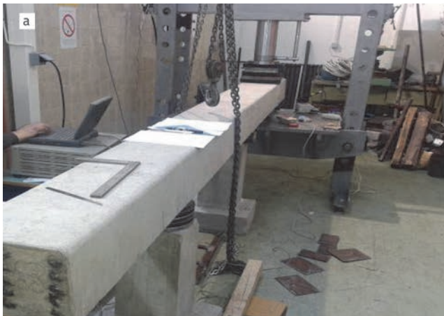
Slika 5. Prikaz dinamičkog ispitivanja praga: a) način oslanjanja praga; b) postupak opterećivanja praga
