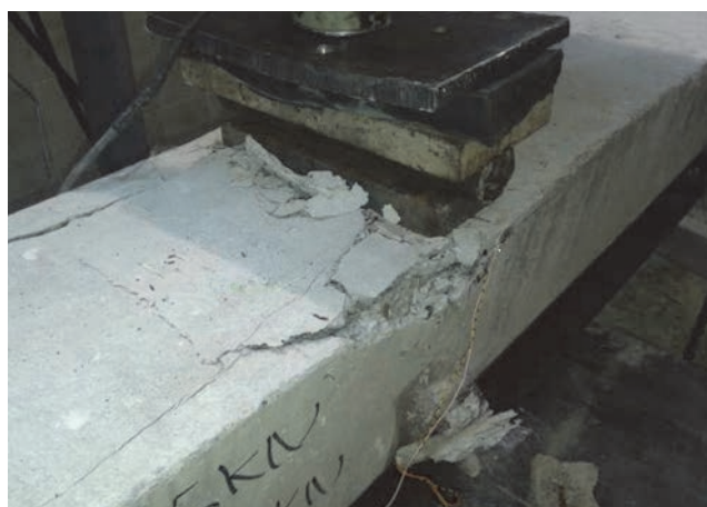
Slika 8. Lom pri dinamičkom ispitivanju skretničkoga praga SP-3 pri F_{cBn} = 210 kN
