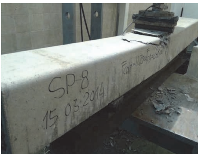
Slika 10. Lom pri dinamičkom ispitivanju skretničkoga praga SP-8 pri maksimalnoj sili F_{cb} = 248 kN
