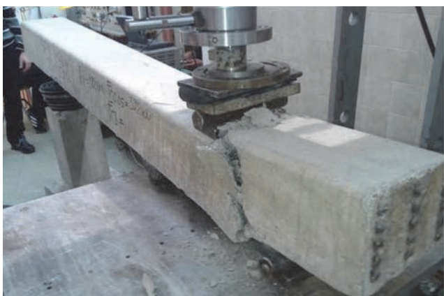
Slika 6. Lom pri dinamičkom ispitivanju reprezentativnog praga L = 4,0 m pri najvećoj sili F_{rb} = 570 kN
