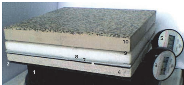
Slika 3. Prikaz ispitnog uzorka u uređaju (1-metalna ploča za izvor toline, 2-tanka plastična ploča, 3-mjerni uređaj termometra, 4-ispitni uzorak poliuretana, 5-kontrolna mjerna ura, 6-tanka plastična ploča, 7-debela plastična ploča, 8-tanka metalna ploča, 9-debela kamena ploča za opterećenje)
